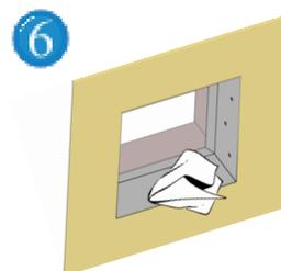
Após o estuque e mesmo após a pintura, limpe os dois quadros de qualquer resíduo. Isso é essencial para que a funcionalidade da tampa de inspeção não seja comprometida.
