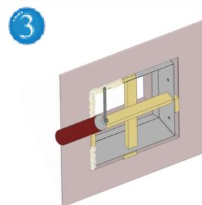
Insira a espuma de poliuretano no espaço entra a estrutura e o muro e deixe secar pelo tempo indicado nas instruções do fabricante.
