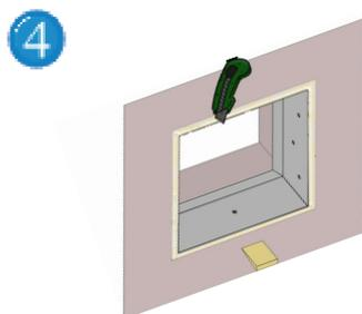
Depois de secar a espuma, remova as cunhas e as travessas e remova o excesso de espuma.
