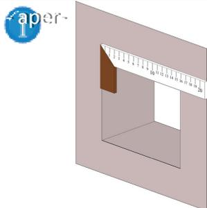
Meça a dimensão do furo da parede e da tampa de inspeção.
