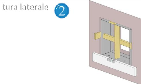
Pegue o telaio externo da tampa e insira-o no furo. Com a ajuda de uma bolha de nível, aponte o quadro, prenda-o com cunhas e insira travessas horizontais e verticais. Preste atenção à direção de abertura: o clique deve estar na parte superior.
